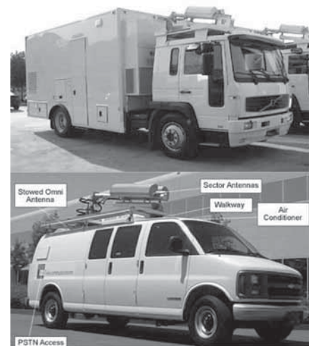
Obr. 4 - Vozidlové mikrosítě GSM Network-On-Wheels firmy interWAVE
