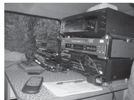
Obr. 6 - Vysielacie pracovisko umiestnené v prenosovom voze Škoda 1203
