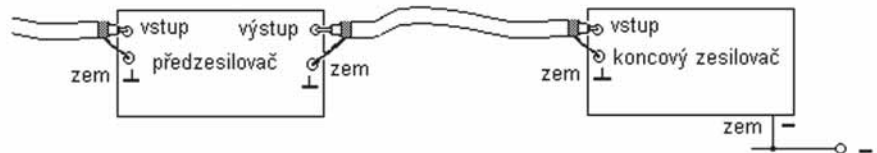
Obr. 2c – Propojení je provedeno stíněným kabelem
