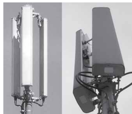
Obr. 6 – Směrové antény na jednom stožáru
