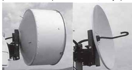
Obr. 1 – Mikrovlnné antény – nahoře krytem, dole bez krytu
