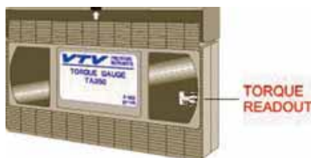
Obr. 6 – Kazeta na meranie krútiaceho momentu je už drahšia – 60 USD
