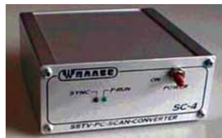
Obr. 10 – Vonkajší vzhľad Scan Convertora určeného pre spoluprácu s Charlie 4
