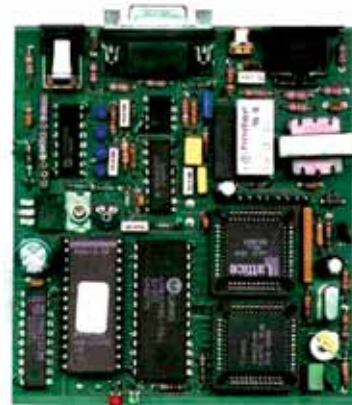
Obr. 3 – Ukážka vnútorného zapojenia Scan Convertora SSTV
