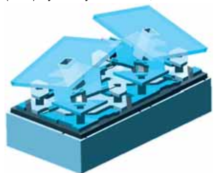
Detail elektrostaticky vychylovaných zrcátek
