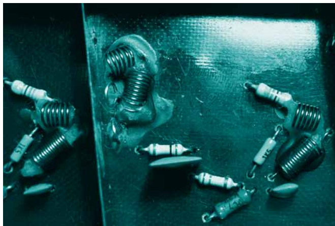
Obr. 5 - Naladený 3. stupeň vhf
