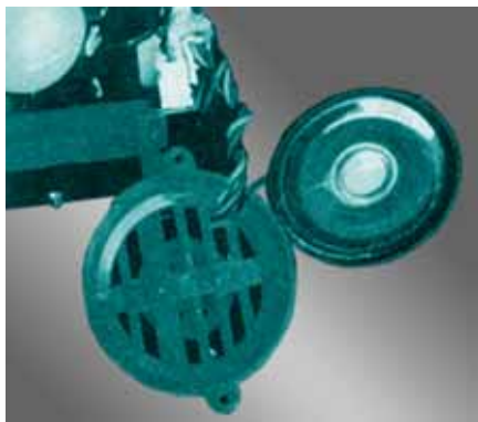
Furbyho reproduktor o průměru 5 cm má velmi čistý zvuk
