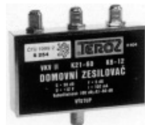
Obr. 7 - Domovní zesilovač: G = 30 dB, F = 5 dB v provedení se závitovými konektory
