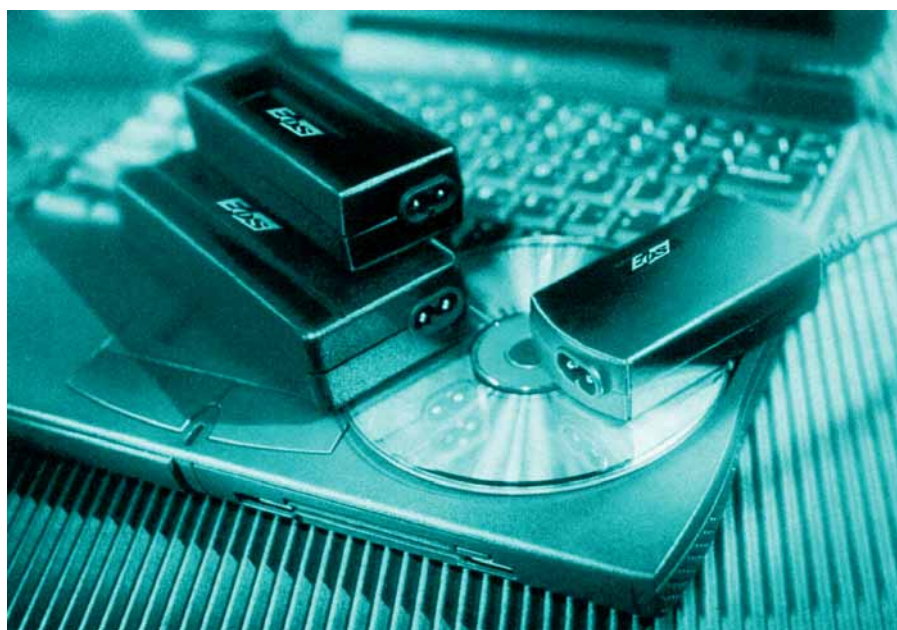
Obr. 2 - Ploché napáječe se spínacovými zdroji již neobsahují transformátory
