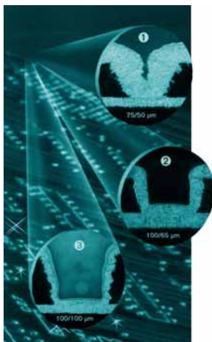
Obr. 2 - Mikroprůchody vrtané laserem a pokovené
