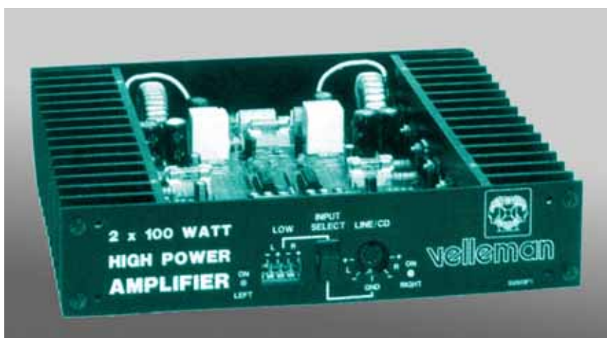
Výkonový zesilovač 2x 100 W do automobilu – stavebnice Velleman K3503; ukážka prístroje s tranzistory
