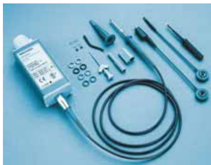
Obr. 14 - Pasivní odporová sonda s aktivním měničem impedance Tektronix P 6939A, 10 : 1, 0 – 500 MHz, vstup 10 MΩ/8 pF, výstup 50 Ω, vstupní napětí 300 V ef , délka 1,3 m
