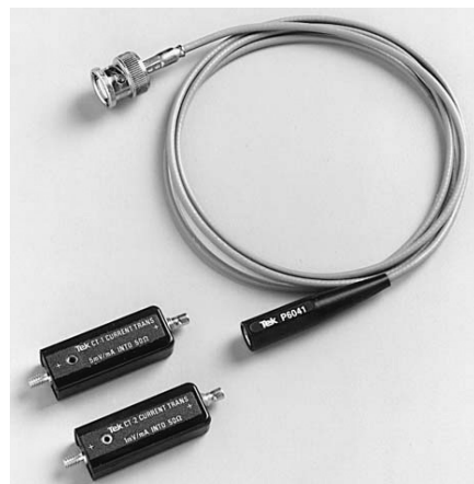
Obr. 15 - Proudové transformátory – sondy Tektronix CT1 a CT2 pro vstup 50 Ω a největší proud 0,3 A; CT1: 25 kHz – 1 GHz, CT2: 1,2 kHz – 200 MHz; vodič s měřeným proudem se provléká otvorem sondy
