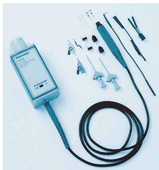
Obr. 12 - Aktivní sonda Tektronix P 6249, 0 – 4 GHz, 5 : 1, vstup 20 kΩ/1 pF, výstup 50 Ω, vstupní napětí -1,75 až +1,75 V, délka 1,3 m
