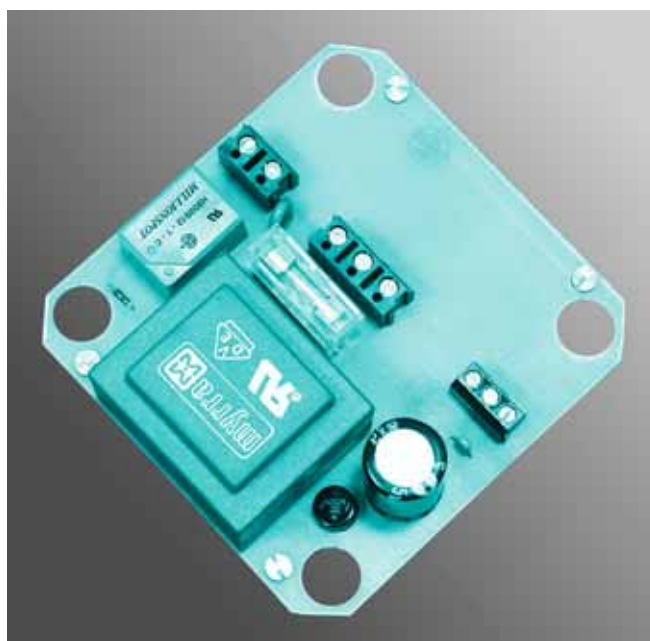
Obr. 9, 10 - A ještě dvakrát zdroj: osazená deska s plošnými spoji samostatná a vložená do krabičky
