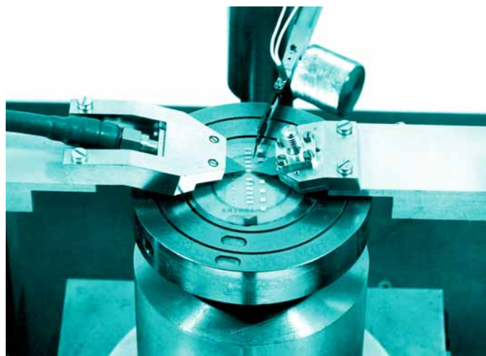
Obr. 123 - Koplanární mikrosondy v kovovém držáku s mikrovláknovými konektory; levá má přímý přechod na konektor, pravá kolmý přechod; na pracovním stolku je položena destička s kalibračními impedancemi
