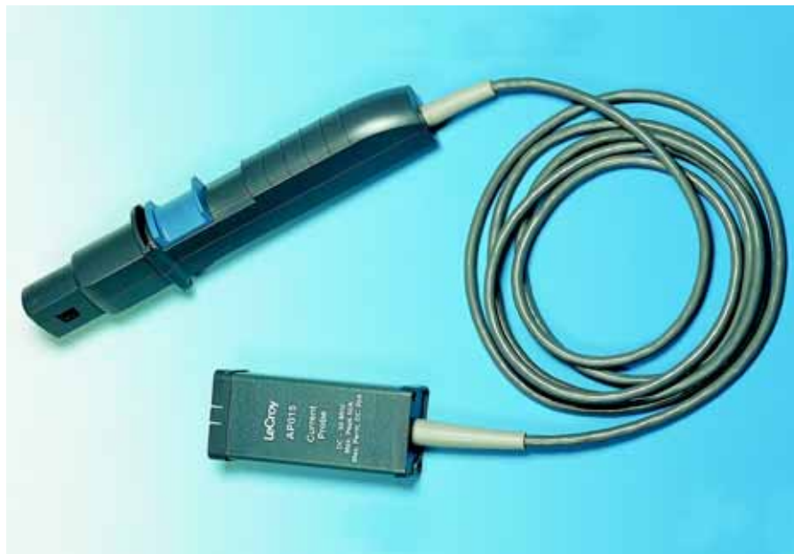
Obr. 110 - Proudová sonda LeCroy AP015 s Hallovým generátorem má kmit. rozsah 0 – 50 MHz a proud měří do 30 A; dobře je vidět jezdec posuvného jádra
