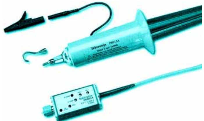
Obr. 87 - Vysokonapěťová pasivní sonda Tektronix P6015 se vstupní impedancí 100 \text{ M}\Omega / 3 \text{ pF} pro napětí 20 kV má kmitočtový rozsah 75 MHz a zeslabuje 1000\times
