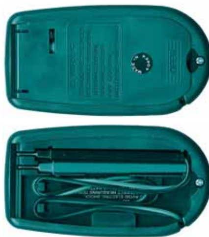
Zadní strana přístroje; ze snímku je patrné praktické provedení včetně promyšleného ukládání měřicích kabelů
