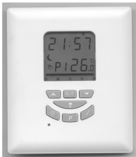
Na fotografii Typ 097E s odstraněným výklopným ochranným krytem
