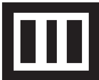
Obr. 5 - Plošný spoj filtra (meritko 1:1)
