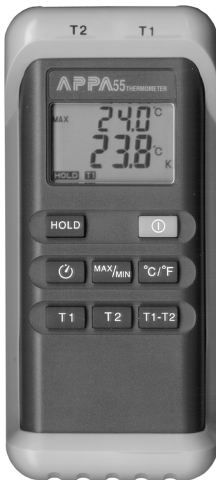
Obr. 2 - Fotografie teploměru v ochranném pouzdru
