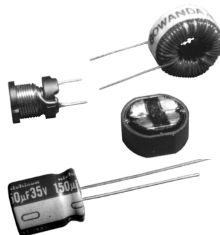
Obr. 6 - Různá provedení cívek a filtrační kondenzátor pro impulzní regulátory s řídicími obvody Maxim
