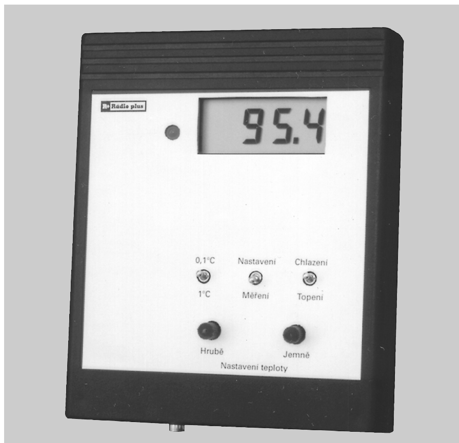
Obr. 5 - Hotový termostat v krabičce
