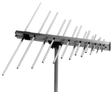
Obr. 17 – Logaritmicko-periodická anténa EMCO 3146 pro kmitočty 200 až 1000 MHz a vyzářený výkon do 1,3 kW
