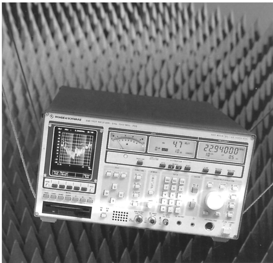
Obr. 13 – Přijímač pro měření rušivých signálů Rohde&Schwarz ESS. V pozadí je bezodrazová stěna s tlumícími jehly
